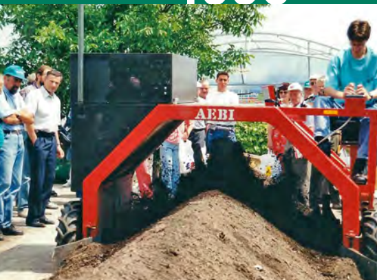
Demonstration einer Kompost-Umsetzmaschine. Démonstration d'un retourneur d'andain de compost.
